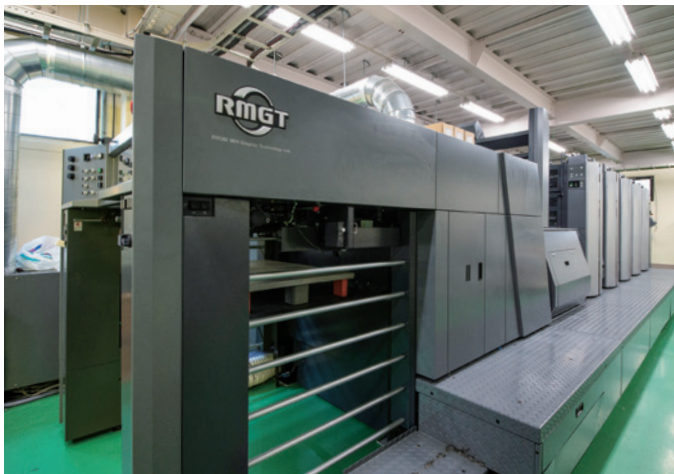
水性/LED-UV 兼用コーティングユニットに、IR/LED-UV 乾燥装置、セミロングデリバリーを備えた A全判4色印刷機 RMGT 940ST-4+LED-UV+CC+SLD
